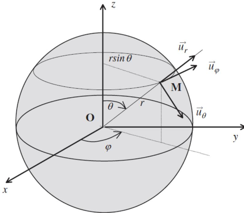
Figure 8 : Système de coordonnées sphériques
