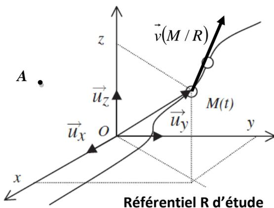
Figure 16 : Position du moment cinétique relativement à un point A dans un référentiel R d'étude
