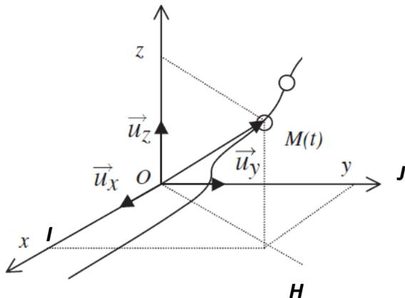
Figure 6 : Système de coordonnées cartésiennes
