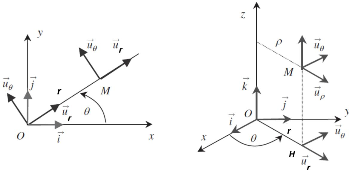
**Figure 7 : Système de coordonnées polaires dans le plan (à gauche) et cylindrique dans l'espace (à droite)**
