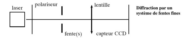
1. Réaliser l'alimentation (continu 12 V) d'un laser à semi-conducteurs ( $\lambda_0$  = 670 nm) ou hélium - néon ( $\lambda_0$  = 632,8 nm) et disposer devant celui-ci un polariseur rectiligne. Observer l'effet de la rotation de ce polariseur sur l'intensité du faisceau de sortie ou devant le capteur CCD . Expliquer.
